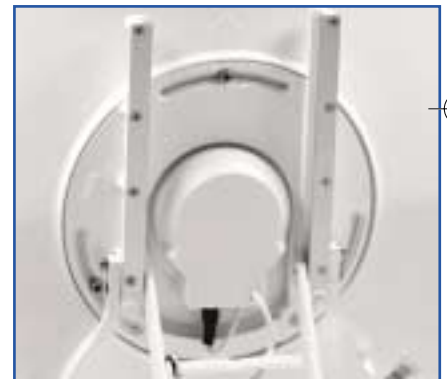
Rückseite CARO-Flachantenne: Manuelle Skew-Anpassung zur Optimierung der Reichweite
